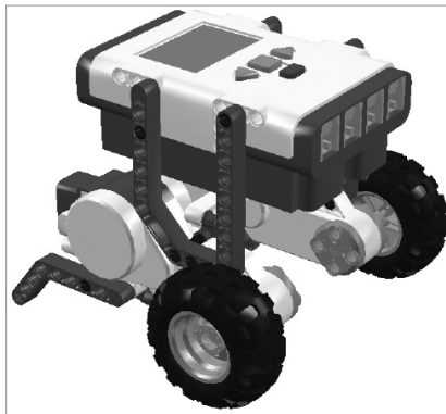
圖 D-9 差速驅動機器人完成
